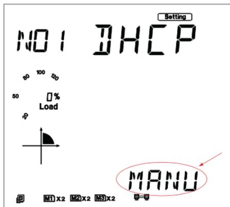
d) Ajuste de la dirección IP en la segunda página de configuración, como ejemplo 192.169.1.100 como se muestra a continuación. Pulse la tecla "V / A", vaya a la configuración de estado. Los usuarios pueden configurar los parámetros de la zona indicada, y el cursor se inicia en el primer bit de dígitos. Después de configurar la dirección IP por completo, "A/V" pulse la tecla de aceptar. Una vez más, pulse la tecla "P", vaya a la página tercer escenario de la máscara de subred.
